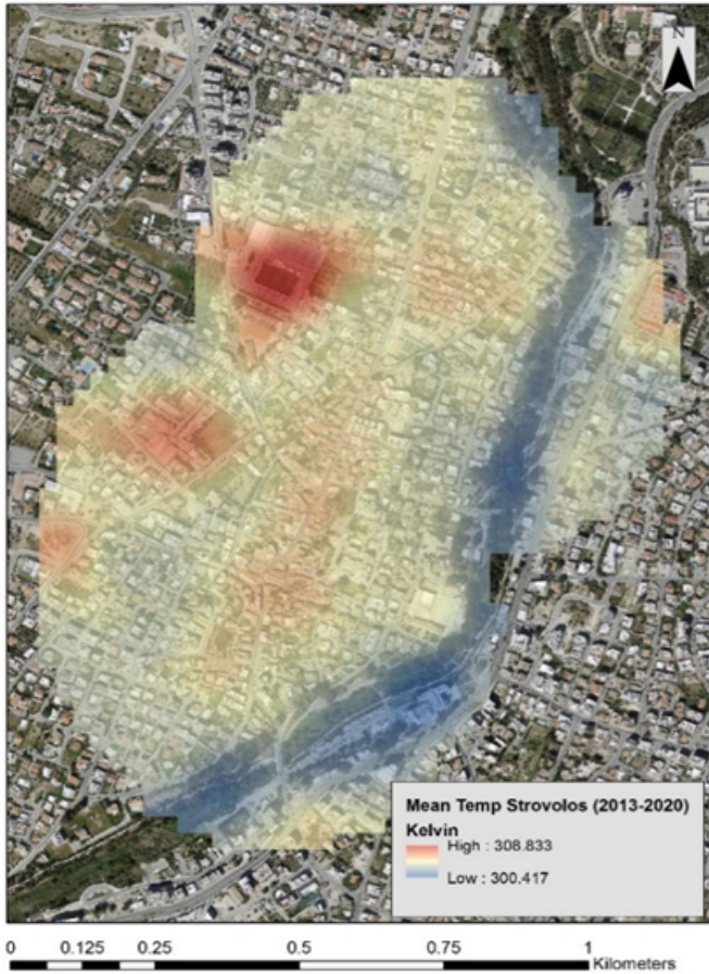
Εικόνα 5 - Αποτέλεσμα ανάλυσης μέσω θερμοκρασιών της περιοχής μελέτης του Δήμου Στροβόλου, για την περίοδο από το 2013 μέχρι το 2020, με χρήση θερμικών εικόνων Landsat
