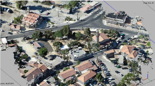
Εικόνα 3: Εναέρια Διερεύνηση Λεμεσού, Dense Point Cloud
